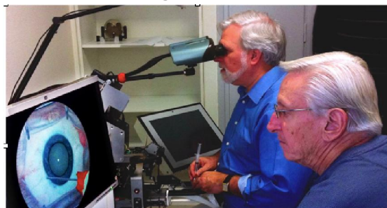
Simulátor operace kataraktu MSICS
